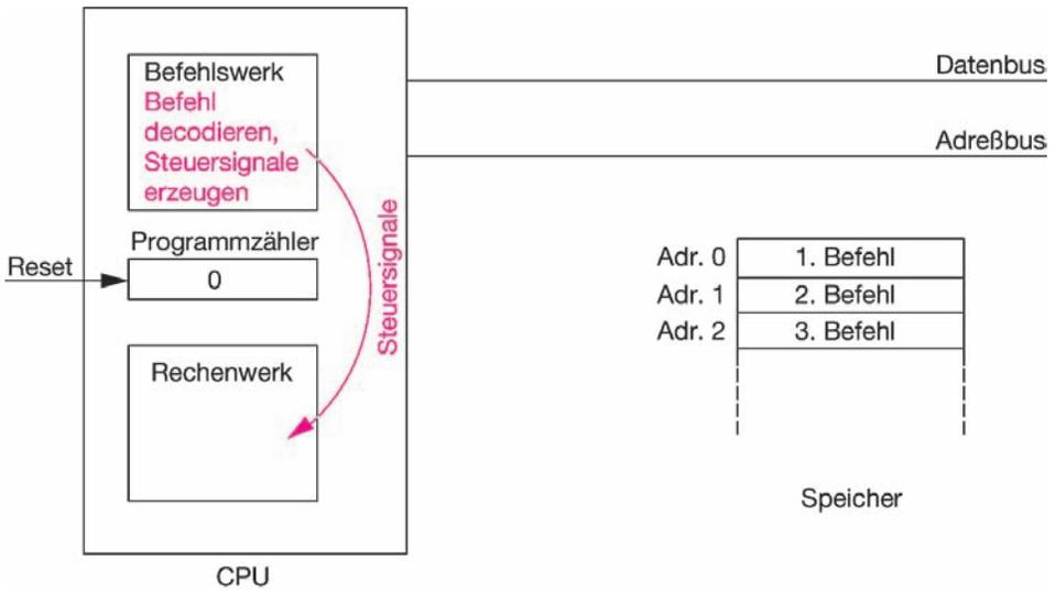
Bild 1.5 Ausführung eines Befehls
