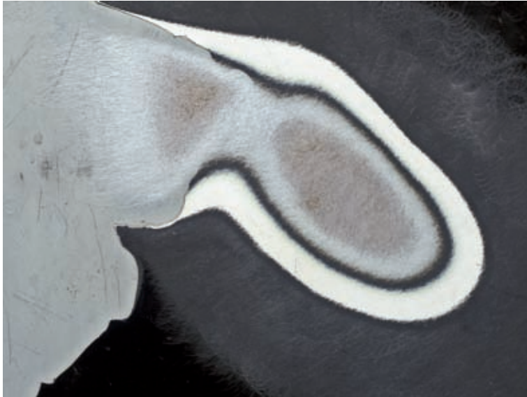
Bild 1-016 Durchschliffmethode anhand von Lackabplatzungen
