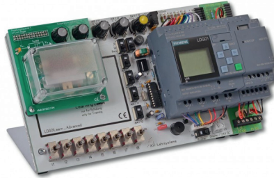
Bild 2-1 Lernsystem LOGO! Learn Advanced mit Plug-on-Modul Regelungstechnik 1 (Zwei-Punkt-Regler) und dem Erweiterungsmodul DM8 12/24R.
