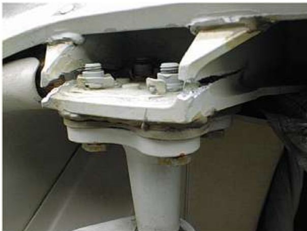
Bild 2.4 Ermüdungsbruch: Aufhängung Kabinentür, Kurbelwelle
