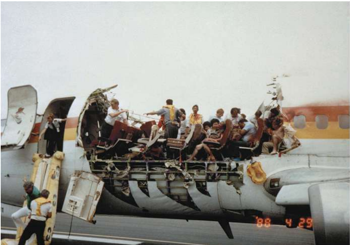
Bild 2.5 Aloha Airlines: Materielle Ermüdung der Zelle
