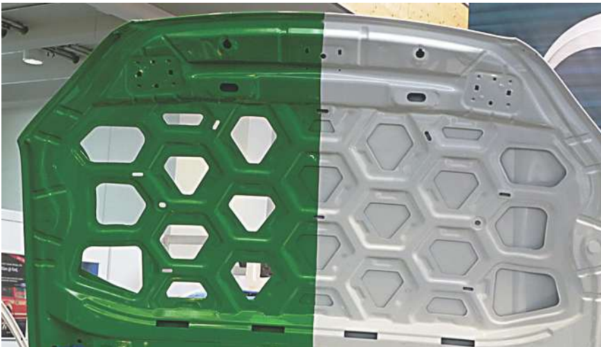
Bild 1.8b Eine nach bionischem Vorbild umgesetzte Motorhaube bei Volvo
