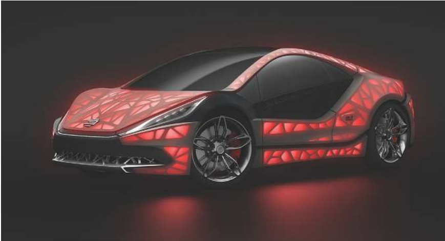
Bild 1.8a Die Blattstruktur als Vorbild für die Gestaltung einer Fahrzeugkarosserie. Die angepasste Gitterausführung ermöglicht geeignete Festigkeitsbereiche für z.B. den Fußgängerschutz. Außerdem kann die Außenhaut aus unterschiedlichen Materialien bestehen, wie die Bespannung mit einem textilen Material am Concept Car „Light Cocoon“ von EDAG zeigt. [Quelle: EDAG]
