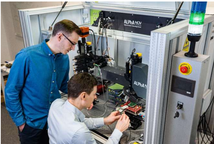
Abbildung 2: Arbeiten an einem Lasermessplatz für Fehlerangriffe auf eingebettete Systeme und darauf ausgeführte kryptografische Implementierungen
